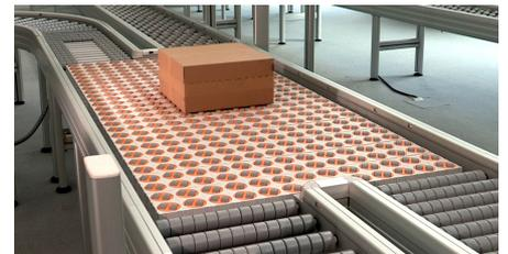
然后有一个小齿轮驱动，用于将两个辊子向所需的方向移动，由一个齿条提供动力，该齿条将所有 OUT-bricks 组合成一条线，这也是由一个 BLDC-Motor 提供动力。
